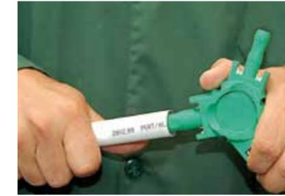
CALIBRATE / DEBURR OF THE PIPE
